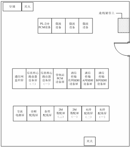
图 1 通信机房改造后机柜分布示意图
